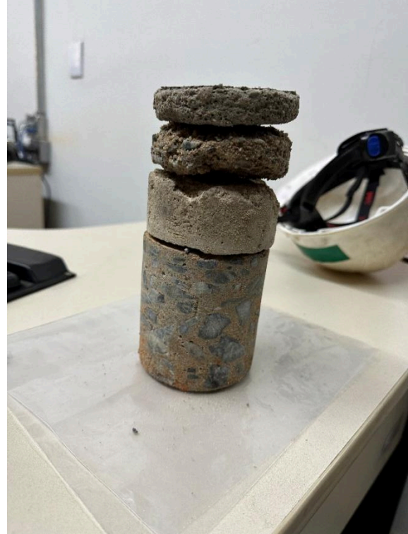
Foto 9: Testemunho retirado da laje e camadas de enchimento encontradas durante a extração
